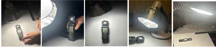
Рисунок 1- Серия фотографий эксперимента с использованием внутреннего каркаса настольной лампы из фольги и белой отражающей поверхности
