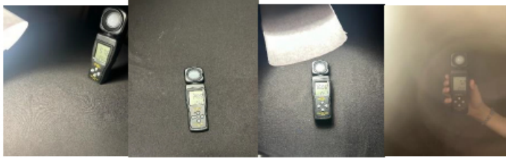
Рисунок 5 – Серия фотографий эксперимента с использованием внутреннего каркаса настольной лампы из белой бумаги и черной отражающей поверхности
